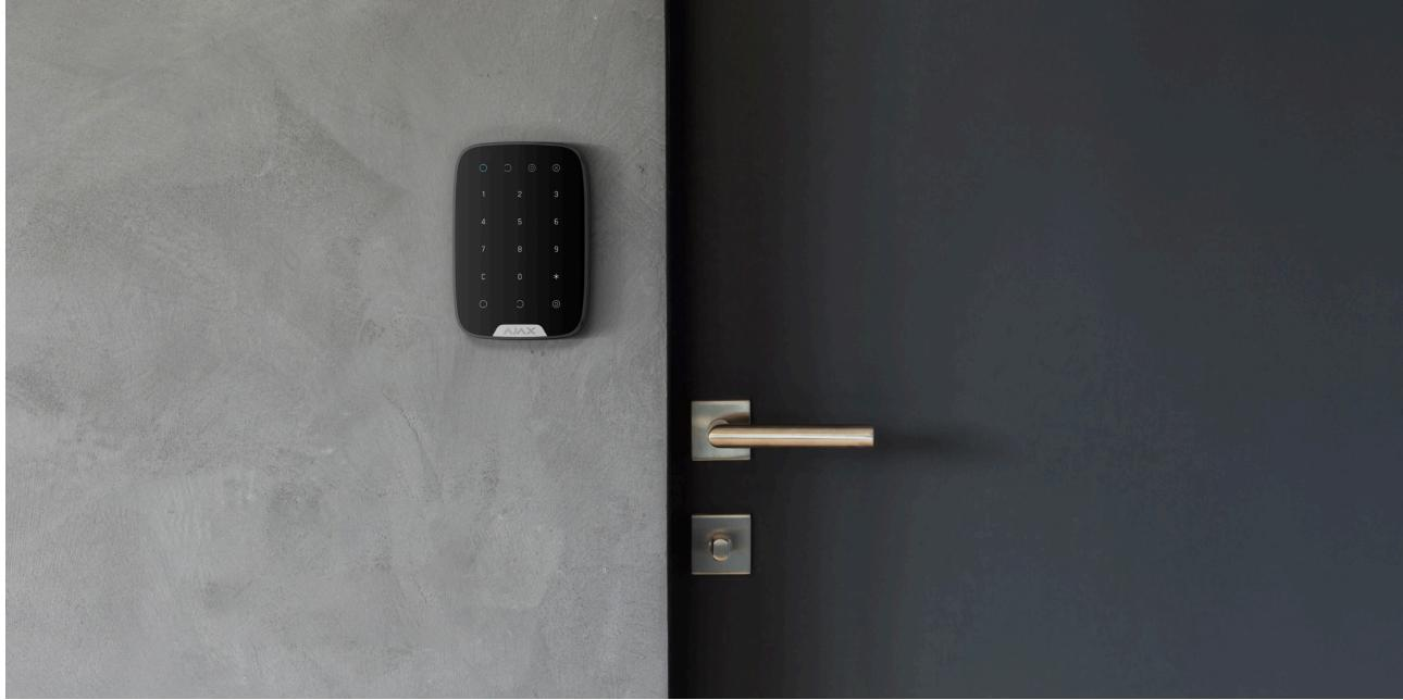
Umístění klávesnice závisí na vzdálenosti od Hubu a na přítomnosti jakýchkoliv překážek mezi zařízeními, která brání přenosu rádiového signálu: stěny, podlahy, velké objekty umístěné v místnosti.
