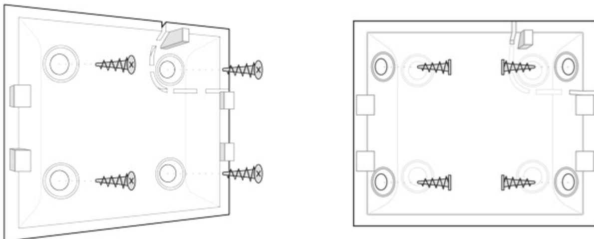
1. Připevněte panel SmartBracket k povrchu pomocí přiložených vrutů pomocí nejméně dvou upevňovacích bodů (jeden z nich – nad tamperem). Po výběru jiného upevňovacího příslušenství se ujistěte, že panel nepoškouje ani nedeformuje.
